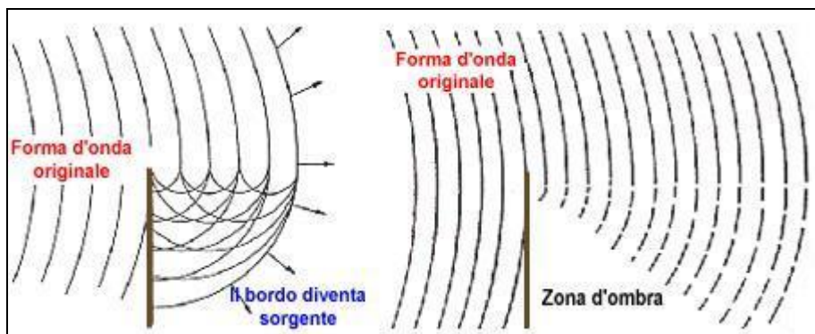
Fig. 1 – Effetti della diffrazione a bassa e alta frequenza su schermi
