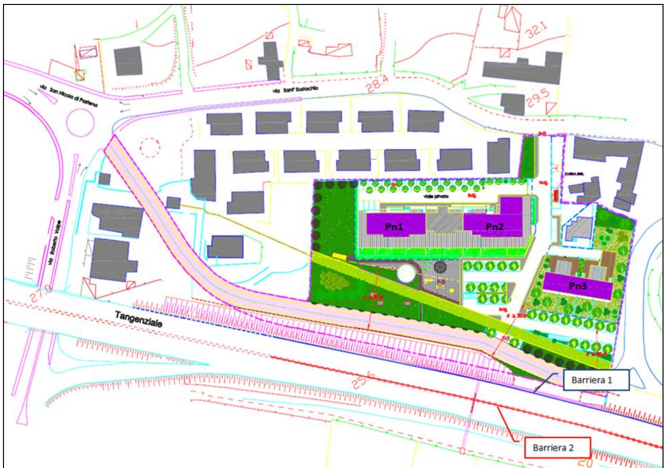
Fig. 11 – Vista in pianta dell'area oggetto di studio, con evidenziato il posizionamento delle nuove barriere (linee blu e rossa)
